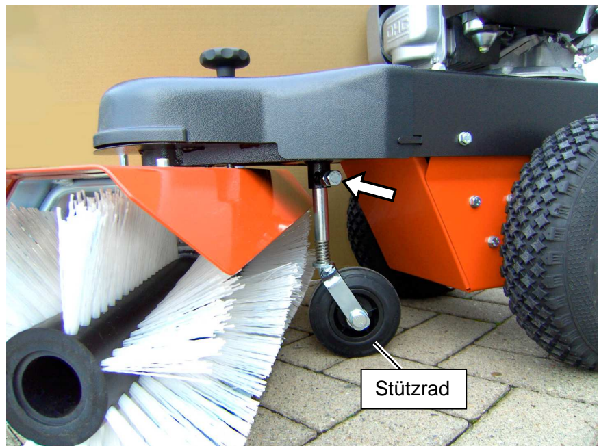
Abbildung 7: Stützrad mit Klemmschraube (Pfeil)
