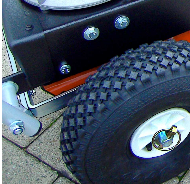
Abbildung 6: korrekte Montage Lenker / Stützwinkel
